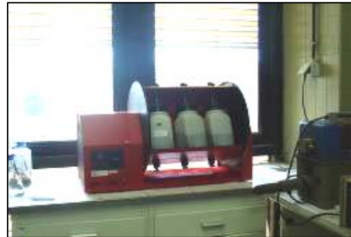
Abb. 2 – Gerät für Leaching-Tests
