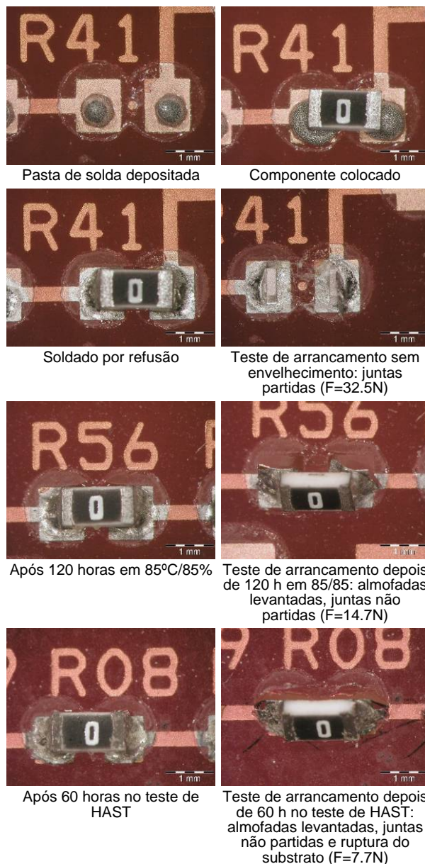
Fig. 1: Controlando a sequência de montagem e o efeito dos testes de 85°C/85% e HAST numa placa flexível de 50 micron de PI com 18 micron de Cobre
