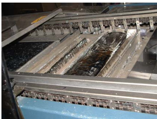
Fotografia 1: Onda de SnPb num equipamento de soldadura por onda
