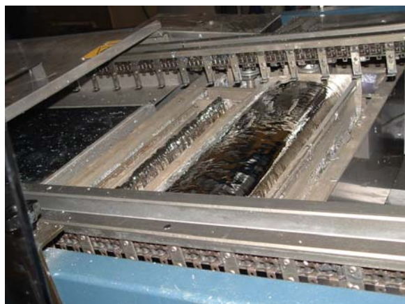
Foto 2: Onda al piombo in un'attrezzatura a saldatura a onda.
