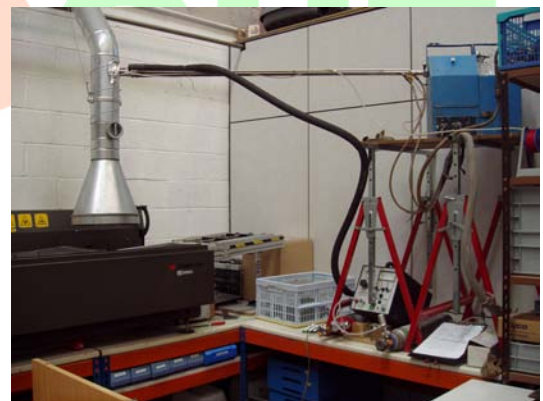
Abb. 3: Emissionsmessung beim Wellenlöten
